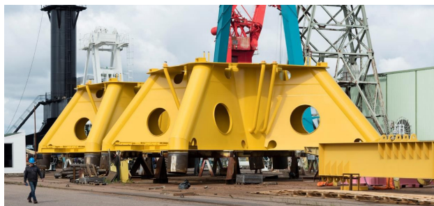
Рис. 2. Во время диагностического тестирования Levator производила по одному 150-тонному переходному элементу каждые 5 рабочих дней
